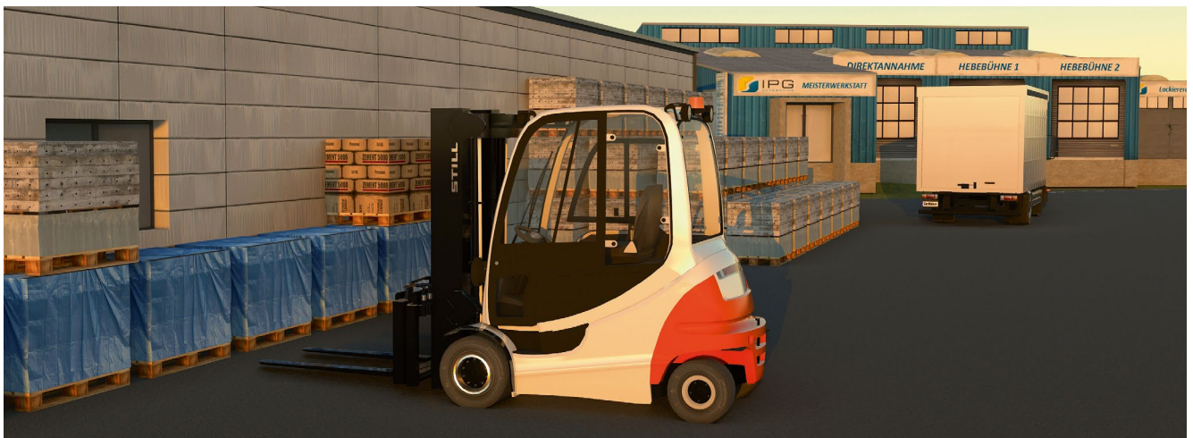
BILD 1 Darstellung eines automatisierten Gabelstaplers in dem 3-D-Visualisierungstool Movie NX (© IPG Automotive)
