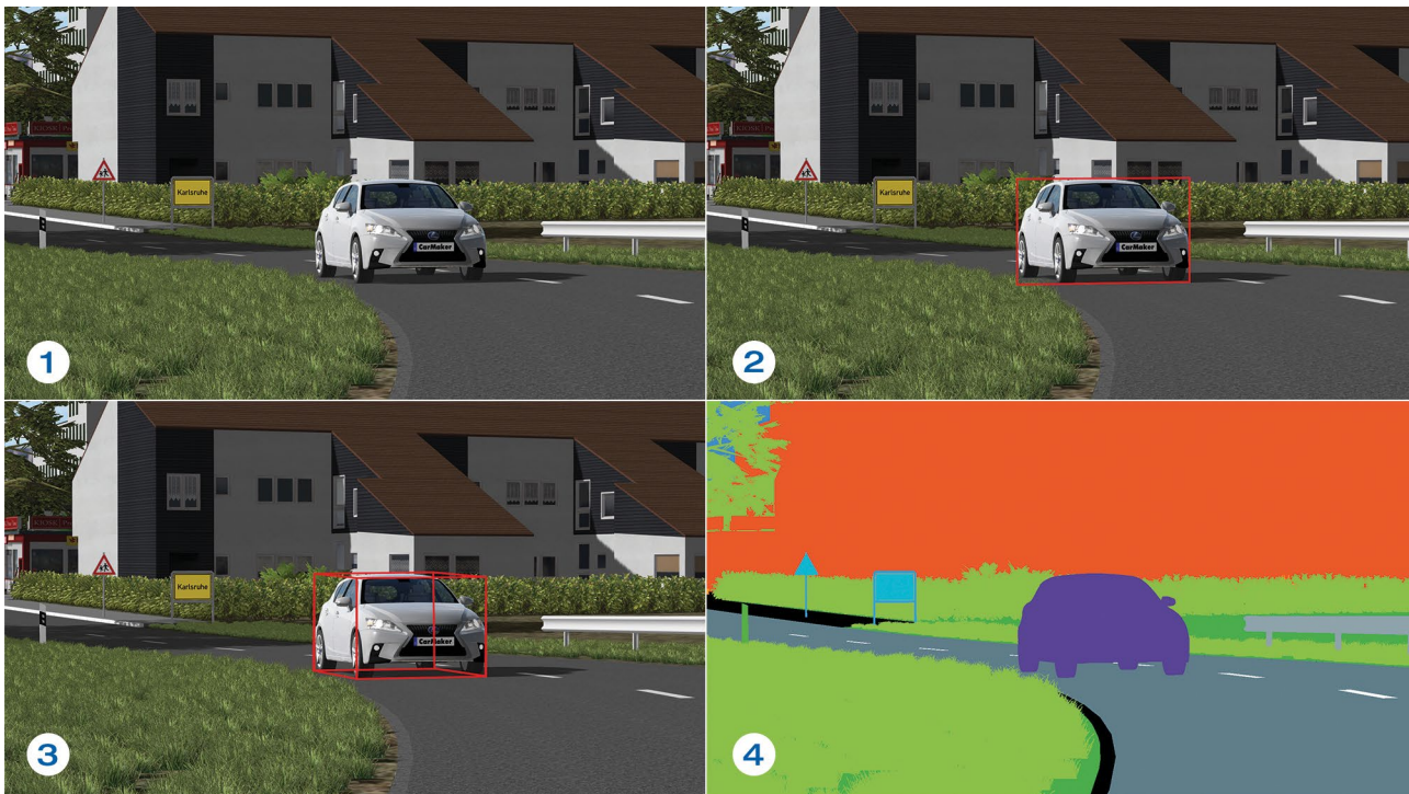
BILD 2 Originales Kamerabild (1), Annotation 2-D-Box (2), Annotation 3-D-Box (3), semantische Segmentierung (4) (© IPG Automotive)
