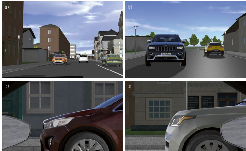
BILD 3 Vier Kamera-RSIs: gewöhnliche Linse vorn (a), hinten (b), rechts (c) und links (d) am Fahrzeug (© IPG Automotive)
